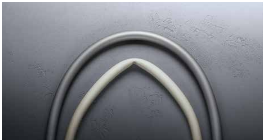
Confronto tra tubo Raxofix 20 x 2,8 mm e tubo composto multistrato standard 20 x 2 mm.
